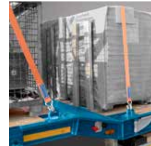
Lastanschlag an Rungen (Formschluss)
