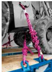
Verzurrung im Außenrahmen und auf der Ladefläche
