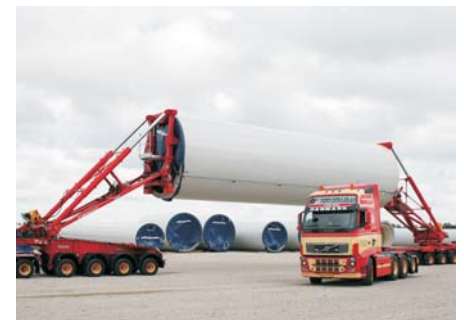
Rohradapter angehoben zum Überfahren von Hindernissen
